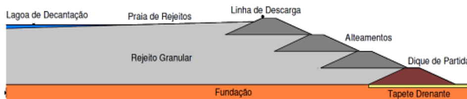
Figura 3 – Método construtivo de montante
